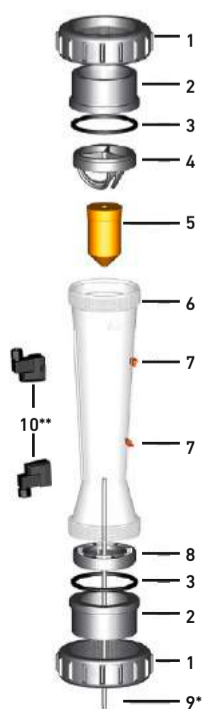
Fig. 1 : Débitmètre avec flotteur
